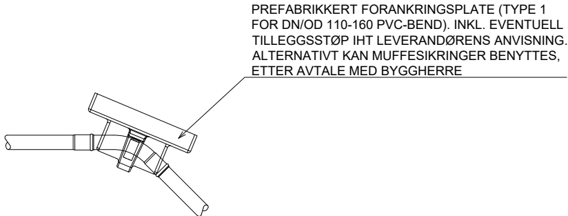
FORANKRING AV PVC TRYKKLEDNINGSBEND
